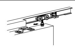
SLOT THE HANGERS INTO THE SLIDING TRACK AND THE RETAINING HOOK FIT THE DOOR PANELS TO THE HANGERS AND FIX THE SLIDING.
